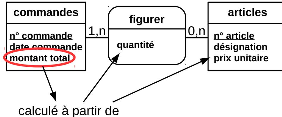
Donc à **retirer du schéma** (présent et calculé côté applicatif)
